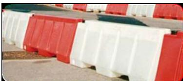
Barriere di sicurezza in polietilene o altro materiale plastico di analoghe caratteristiche, tipo new-jersey, dotate di tappi di introduzione ed evacuazione, da riempire con acqua o sabbia per un peso, riferito a elementi di **1 m**, di circa **8 kg** a vuoto e di circa **100 kg**, nel caso di zavorra costituita da acqua.
